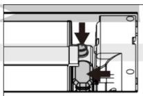
2. Conecte el enchufe de carga y el enchufe de alimentación del controlador a la batería.
