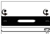
1. Desatornille el tornillo de la cubierta del pedal en sentido contrario a las agujas del reloj.
