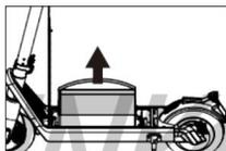
4. Levante la correa de la batería y saque la batería.
