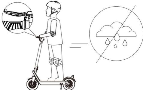
5. Sostenga firmemente la empuñadura del freno para reducir la velocidad y detenerse.
